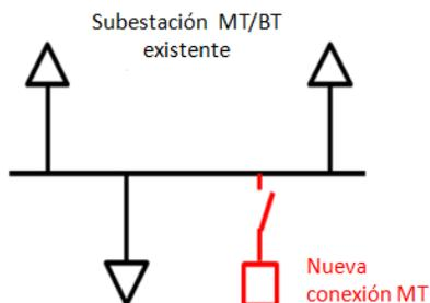
Figura 9 Derivación en T ramificada con seccionamiento.
