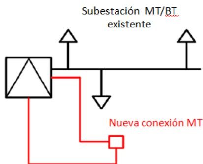
Figura 5 Derivación radial doble desde la subestación AT/MT.
