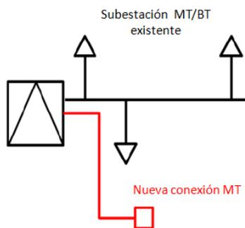
Figura 8 Conexión radial desde una subestación primaria.
