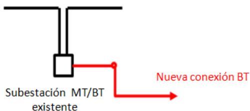
Figura 2 Conexión radial desde una subestación secundaria.
